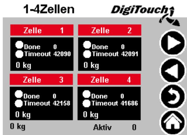
Deaktivieren Sie alle Wiegezone an der Steuerung, indem Sie auf das schwarze Feld (Done & Timeout) drücken. Schwarzer Balken verschwindet!
