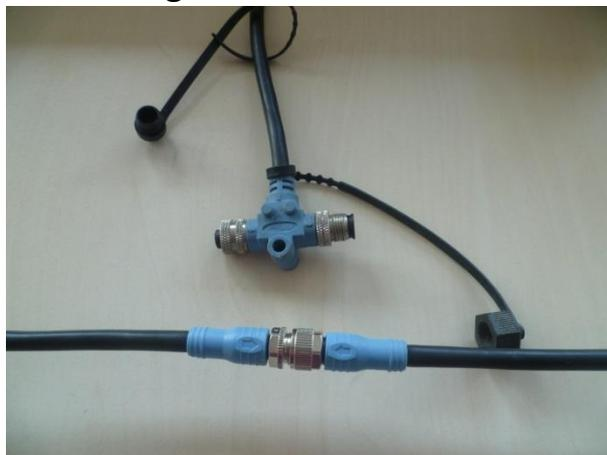
Damit nicht bei einer falschen Zelle die Adresse überschrieben wird, müssen alle Zellen außer die Betroffene Zelle vom Ring getrennt werden. Dazu einfach das Kabel mit dem T-Stück entfernen und die beiden offenen Enden zusammenschrauben (siehe Bild).
